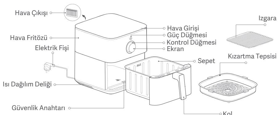
Notlar: 1. Kızartma tepsisinde kullanılan silikon kauçuk, kızartma tepsisinin kenarlarının sepelin kaplamasını çizmesini önlemek ve kızartma tepsisinin sabit durmasını güçlendirmek için yüksek sıcaklığa dayanıklı gıdada kullanılabilir malzemelerden üretilmiştir. Silikon kauçuğu kızartma tepsisinden çıkarmayın.
