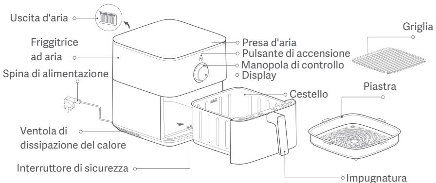
Note: 1. La gomma siliconica usata nella piastra è fatta di materiali ad uso alimentare resistenti alle alte temperature per evitare che i bordi della piastra graffino il rivestimento del cestello e per migliorare la stabilità della piastra. Non rimuovere la gomma siliconica dalla piastra.
