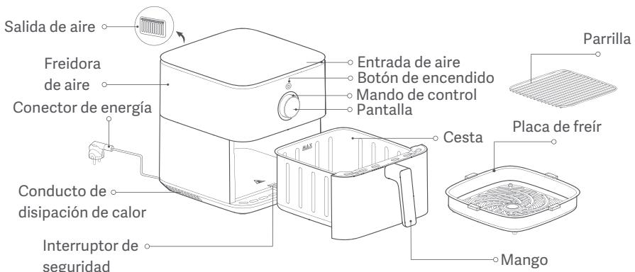
Notas: 1. La goma de silicona de la placa de freír está hecha de materiales de grado alimentario resistentes a altas temperaturas para evitar que los bordes de la placa de freír rayen el revestimiento de la cesta y para mejorar la estabilidad de la placa de freír. No retire la goma de silicona de la placa de freír.
