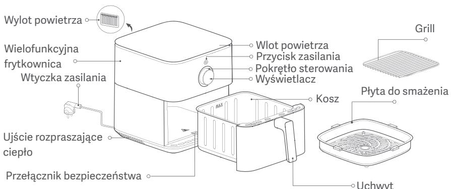
Uwagi: 1. Silikonowa guma na płycie do smażenia wykonana jest z materiałów dopuszczonych do kontaktu z żywnością, odpornych na wysoką temperaturę, które zapobiegają zdrapaniu warstwy kosza przez krawędzie tej płyty i zwiększa jej stabilność. Nie usuwaj silikonowej gumy z płyty do smażenia.
