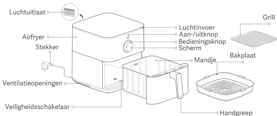
Opmerkingen: 1. Het siliconen rubber dat wordt gebruikt in de bakplaat, is gemaakt van hittebestendige materialen die geschikt zijn voor voedingsmiddelen om te voorkomen dat de randen van de bakplaat de coating van het mandje bekassen en om de stabiliteit van de bakplaat te verbeteren. Het siliconen rubber niet verwijderen van de bakplaat.
