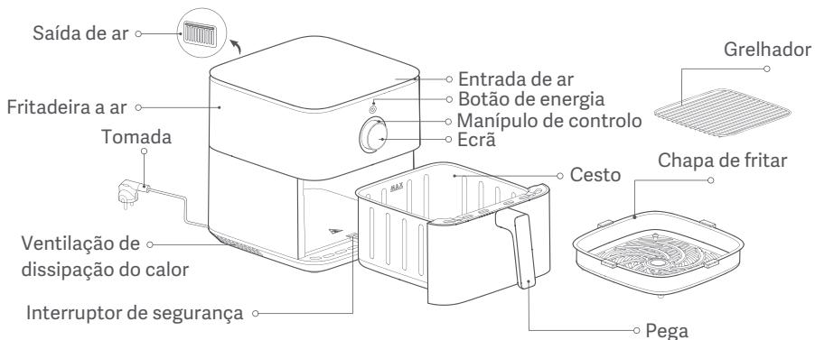
Notas: 1. A borracha de silicone usada na chapa de fritar é feita a partir de materiais de qualidade alimentar resistentes a alta temperatura para prevenir que as bordas da chapa de fritar raspem o revestimento do cesto e para melhorar a estabilidade da chapa de fritar. Não remova a borracha de silicone da chapa de fritar.
