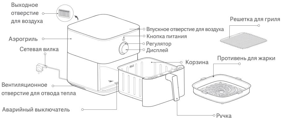
Примечания: 1. Силиконовый каучук на противне для жарки изготовлен из жаропрочных материалов, пригодных для пищевых продуктов, что позволяет предотвратить царапание краями противня для жарки покрытия корзины и повышает устойчивость противня. Не удаляйте силиконовый каучук с противня для жарки. 2. Слишком мелкие ингредиенты не подходят для решетки для гриля. Следите за тем, чтобы ингредиенты не попадали в отверстия решетки для гриля.
