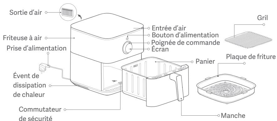
Remarques : 1. Le caoutchouc en silicone utilisé dans la plaque de friture est fait de matériaux en contact avec les aliments hautement résistants à la température pour empêcher que les bords de la plaque de friture ne grattent le revêtement du panier et d'améliorer la stabilité de la plaque de friture. Ne pas enlever le caoutchouc en silicone de la plaque de friture.
