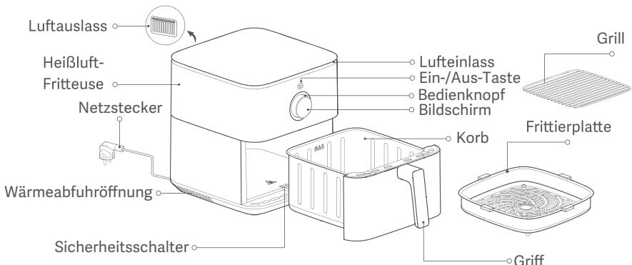
Hinweise: 1. Der Silikongummi auf der Frittierplatte besteht aus hochtemperaturbeständigen, lebensmittelechten Materialien, um zu verhindern, dass die Kanten der Frittierplatte die Beschichtung des Korbes zerkratzen und um die Stabilität der Frittierplatte zu verbessern. Entfernen Sie das Silikongummi nicht von der Frittierplatte.
