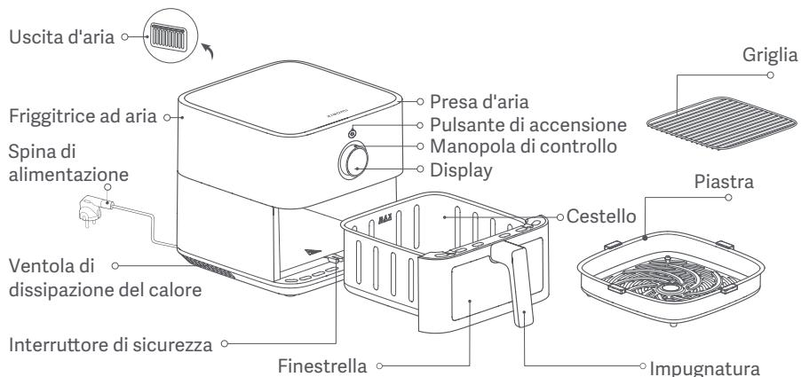
Note: 1. La gomma siliconica usata nella piastra è fatta di materiali ad uso alimentare resistenti alle alte temperature per evitare che i bordi della piastra graffino il rivestimento del cestello e per migliorare la stabilità della piastra. Non rimuovere la gomma siliconica dalla piastra.
