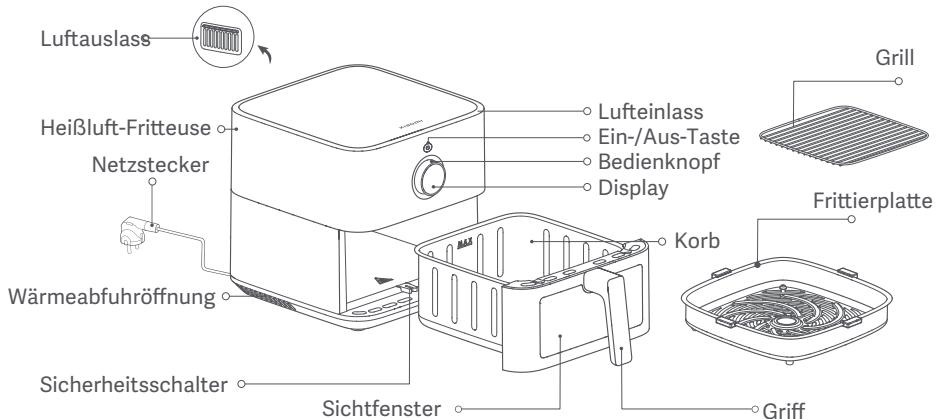
Hinweise: 1. Der Silikongummi auf der Frittierplatte besteht aus hochtemperaturbeständigen, lebensmittelechten Materialien, um zu verhindern, dass die Kanten der Frittierplatte die Beschichtung des Korbes zerkratzen und um die Stabilität der Frittierplatte zu verbessern. Entfernen Sie das Silikongummi nicht von der Frittierplatte.
