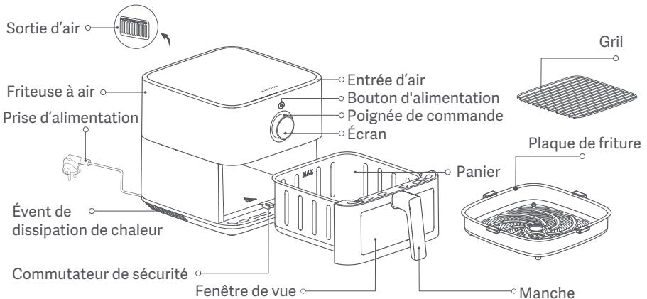
Remarques : 1. Le caoutchouc en silicone utilisé dans la plaque de friture est fait de matériaux en contact avec les aliments hautement résistants à la température pour empêcher que les bords de la plaque de friture ne grattent le revêtement du panier et améliorer la stabilité de la plaque de friture. Ne pas enlever le caoutchouc en silicone de la plaque de friture.
