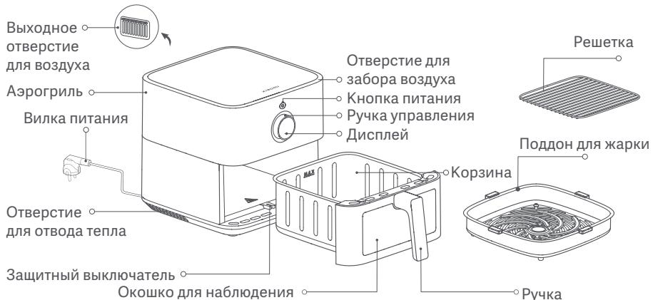
Примечания: 1. Силиконовый каучук на поддоне для жарки изготовлен из жаропрочных материалов, пригодных для пищевых продуктов, чтобы предотвратить царапание краями поддона для жарки покрытия корзины и улучшить устойчивость поддона для жарки. Не удаляйте силиконовый каучук с поддона для жарки.
