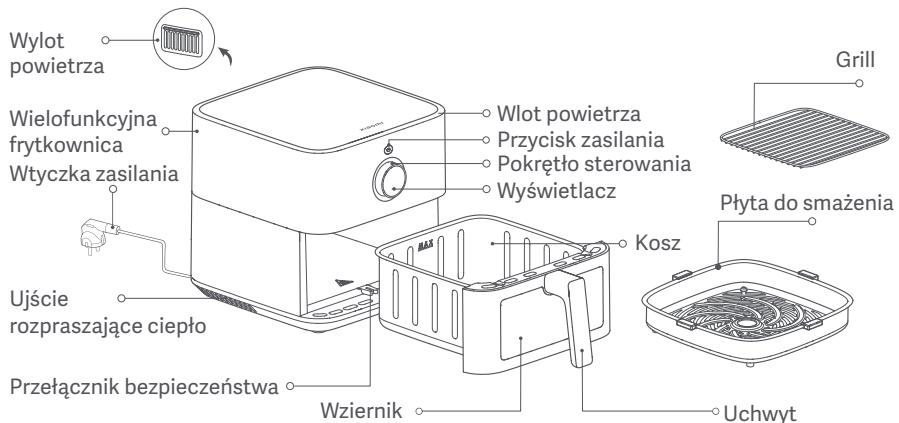
Uwagi: 1. Silikonowa guma na płycie do smażenia wykonana jest z materiałów dopuszczonych do kontaktu z żywnością, odpornych na wysoką temperaturę, które zapobiegają zdrapaniu warstwy kosza przez krawędzie tej płyty i zwiększają jej stabilność. Nie usuwaj silikonowej gumy z płyty do smażenia.
