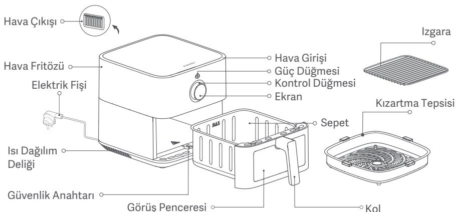
Notlar: 1. Kızartma teşpisinde kullanılan silikon kauçuk, kızartma teşpisinin kenarlarının sepentin kaplamasını çizmesini önlemek ve kızartma teşpisinin sabit durmasını güçlendirmek için yüksek sıcaklıkta dayanıklı gıdada kullanılabilir malzemelerden üretilmiştir. Silikon kauçuğu kızartma teşpisinden çıkarmayın.
